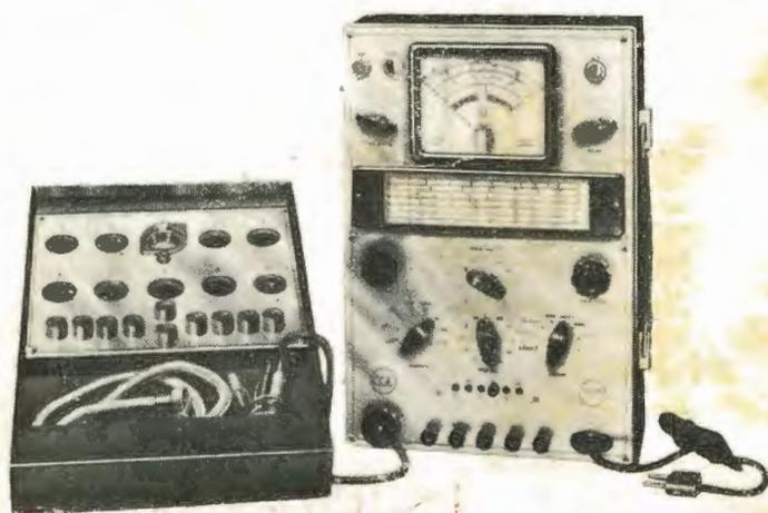
Oscillatore - Misuratore Universale - Provavalvole
